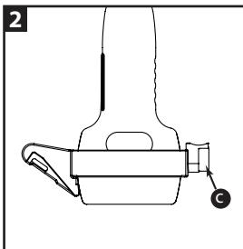
**Nota:** Certifique-se que o suporte está firmemente encaixado na sonda e está alinhado, conforme apresentado.
